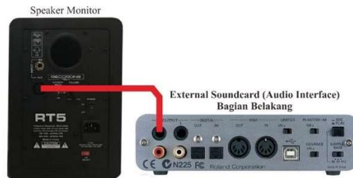
Gambar 17. Instalasi *loudspeaker* dengan *External Soundcard* ([www.roland.com](http://www.roland.com))
