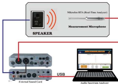
Gambar 18. Instalasi Pengambilan data teknis *loudspeaker*
